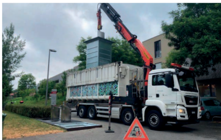
Hakenfahrzeug beim Leeren einer Hauskehricht-Sammelstelle
